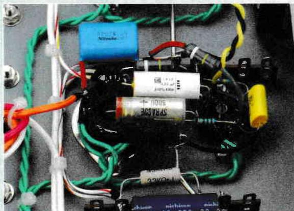
初段管(右側)と出力管ソケットまわりの配線。抵抗、コンデンサーは真空管ソケットと共締めしたラグ板やアース母線に配線
