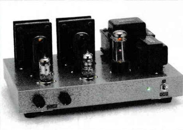
現行生産の真空管に重点を置き、PMの6V6GT、エレクトロ・ハーモニックスのEF86、ソヴテックの5Y3GTを使用して出力3Wのシングルアンプを製作した。出力管のプレートから初段のカソードに11dBのPK帰還をかけるという、いたってシンプルな回路構成である。抵抗、コンデンサーなどはコストを気にしないで良質のものを使用。出力トランスは染谷電子から新しく発売されたオリエントコア採用のA76048を使用した。この出力トランスの特性を反映して、周波数特性は10Hz~40kHzで-1dBと十分な帯域を確保。音楽を奏でてくれるアンプに仕上がった。
